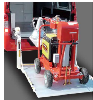
発電機・投光器ユニット
