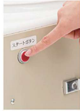
安全カバーを開めて、スタートボタンを押す。 ※安全カバーを開めないで作動しません
